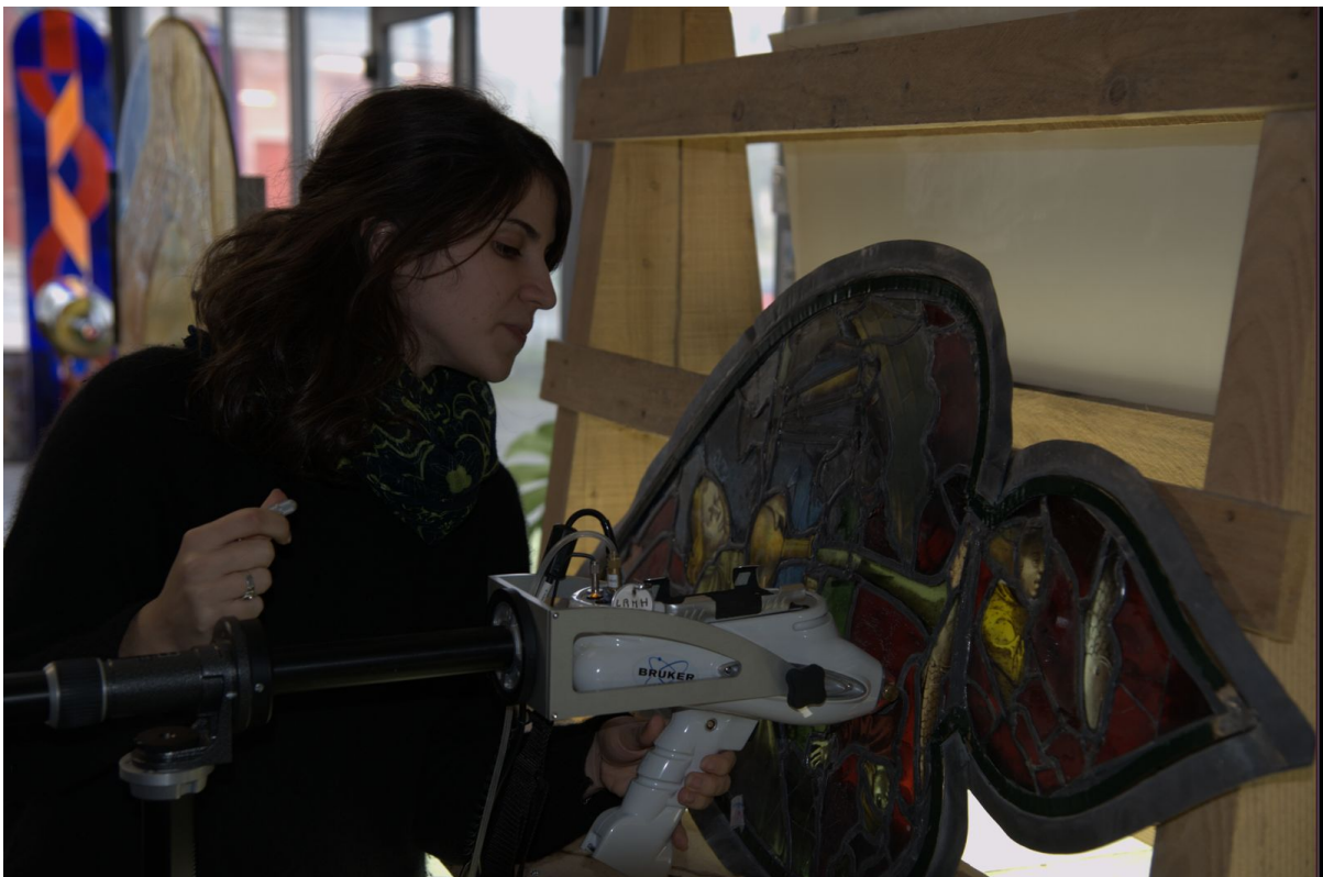
Photo 2 : Analyse chimique non-destructive par fluorescence X portable (Fanny Bauchau, LRMH).
